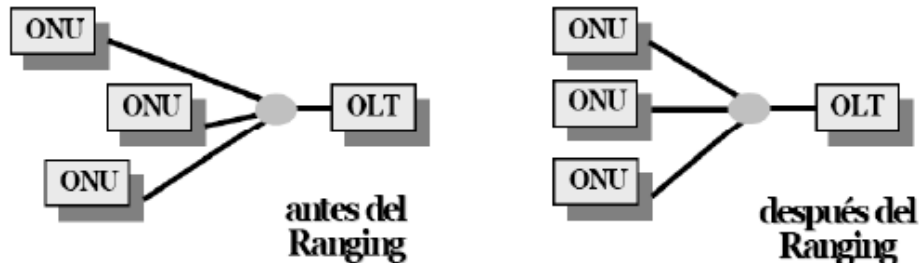
Figura 17 Mecanismo de Ranging en redes PON.
