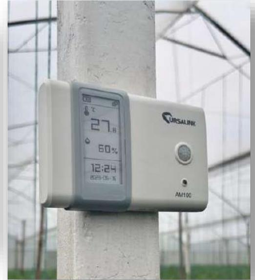
Sistema de sensores para mediciones en aire de temperatura y humedad relativa
