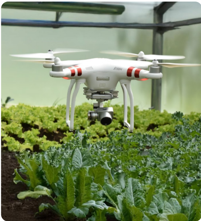
Drone con cámara multiespectral haciendo vigilancia de cultivos de lechuga en invernadero
